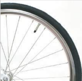
520mmサイズには 700Cのタイヤ & 英式バルブを採用
