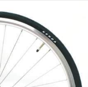
430mmサイズには 26インチのタイヤ & 英式バルブを採用
