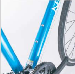
ボトルケージ等を取り付け る為のダボを用意
